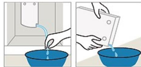
■水抜きホースタイプ      ■水抜きホースなしタイプ
